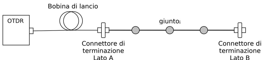
Figura 3: schema di misura delle fo sui giunti di linea / spillamento
