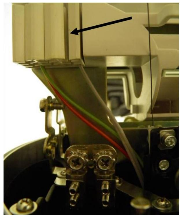
12) Sistemare le fibre all'interno dei moduli di giunzione rispettando i criteri di riempimento indicati
