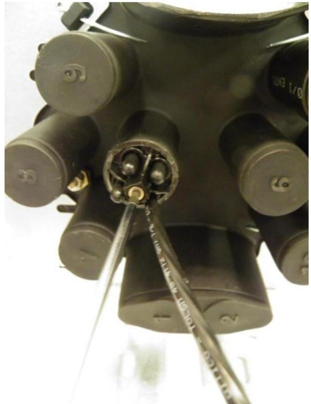
11) Sguainare i tubetti Loose del cavo facendo attenzione a far coincidere il punto di sguaino all'interno della zona di fissaggio dei tubetti e posizionare i singoli tubetti nella zona di fissaggio come evidenziato nella foto;
